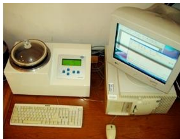
Rys. 6. Stanowisko badawcze separatora sitowego z przedmuchem sit strumieniem powietrza LPS200MC z układem rejestrującym
